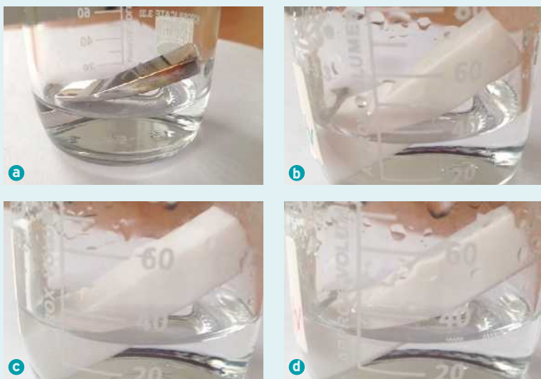
La comparaison de l'effet de corrosion a été effectuée entre des échantillons immergés dans le VHP pendant 3 mois : a) échantillon d'acier inoxydable ; b) échantillon de résine ; c) échantillon de résine de Hanex ; d) échantillon de résine Hi-Macs.
