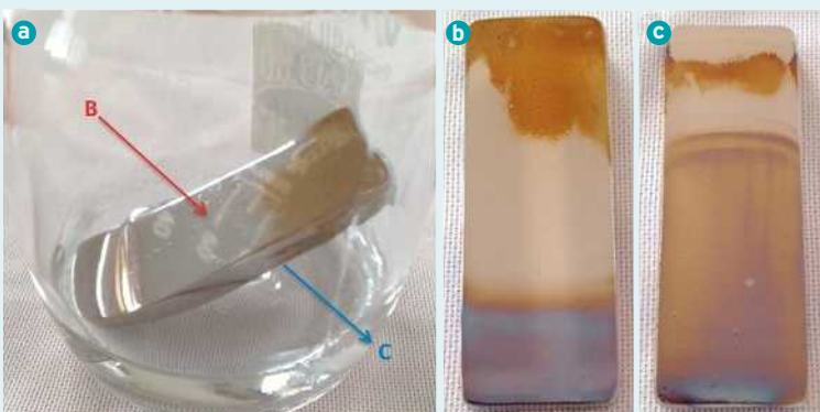
La vapeur de peroxyde d'hydrogène laisse des traces sur l'acier inoxydable.
